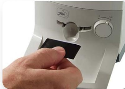
**2** Speicherfolie wird in nur einem Schritt eingescannt und gelöscht. Die Speicherfolie kann wiederverwendet werden.
